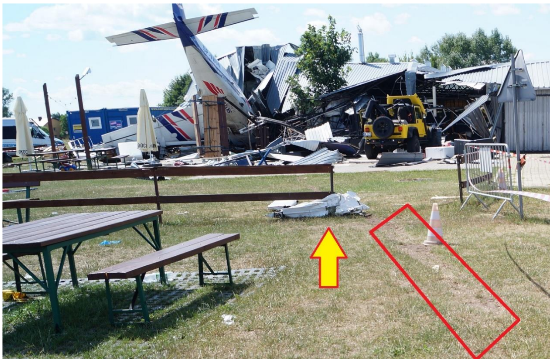
Rysunek 12. Miejsce wypadku. Czerwoną ramką oznaczono ślad końcówki lewego skrzydła pozostawiony na trawie przed budynkiem. Żółtą strzałką oznaczono końcówkę lewego skrzydła, która uległa oderwaniu na skutek kolizji skrzydła z ogrodzeniem budynku
