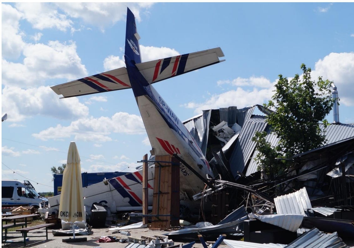
Rysunek 4. Samolot Cessna 208B, SP-WAW – wrak przed oddzieleniem go od konstrukcji budynku (na zdjęciu widać stół, którym prowizorycznie podparto ogon samolotu, aby się przypadkowo nie przemieścił)
