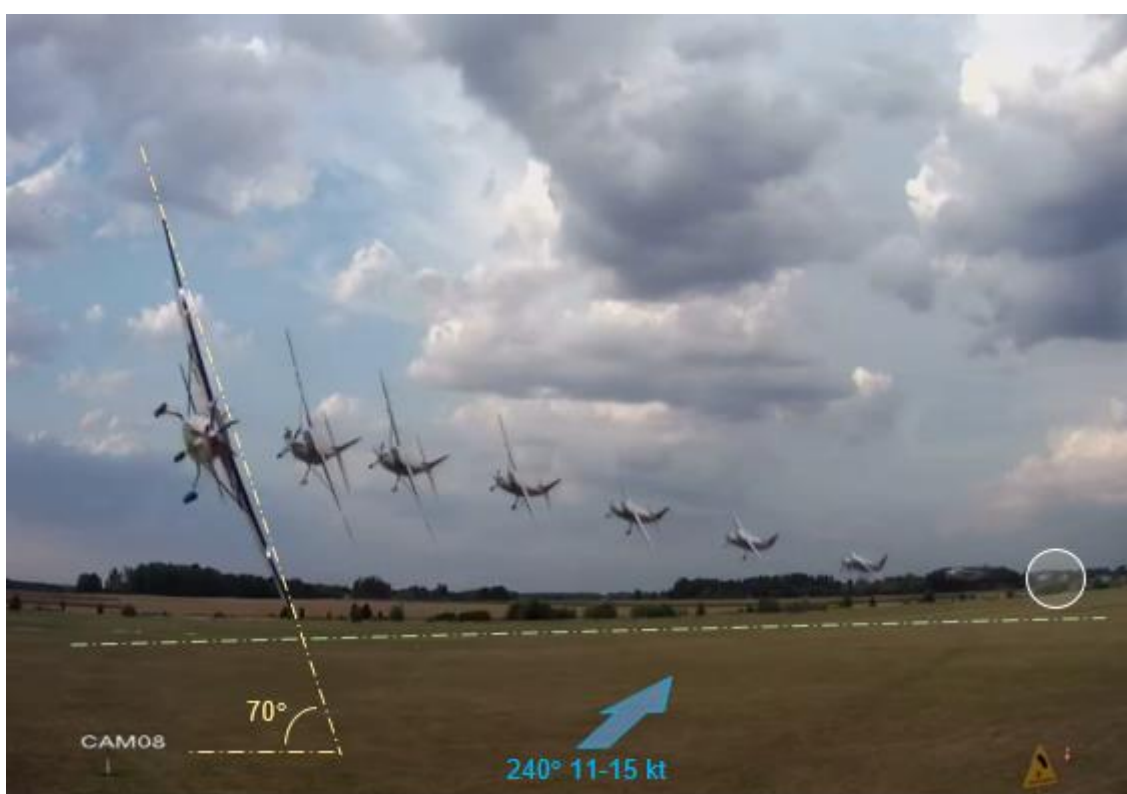
Rysunek 1. Cessna 208B, SP-WAW, po wykonaniu konwojera, gdzie: przejęcie sterowania przez pilota-instruktora – biały okrąg, kąt przechylenia – żółta linia przerywana, oś drogi startowej – zielona linia przerywana, przybliżony kierunek wiatru – strzałka niebieska
